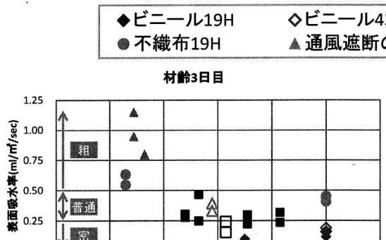
図-18 材齢3日目 表面吸水率と水分量
